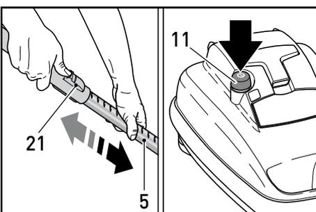
Das Teleskoprohr (5) sollte vor Arbeitsbeginn auf die gewünschte Arbeitshöhe eingestellt werden. Dies geschieht durch Betätigung der Schiebetaste (21). Schalten Sie nun das Gerät durch Drücken des Schaltknopfes (11) ein. Ihr SEBO AIRBELT K läuft besonders sanft an.
