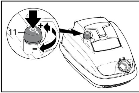
Die gewünschte Saugkraft können Sie je nach Geräteausstattung von 0 (Stand by-Modus) bis max. mit dem Schieberegler (22) im Handgriff (6) bzw. durch Drehen des Schaltknopfes (11) am Gerät regulieren.
